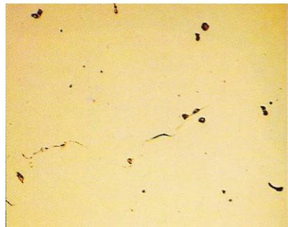
La microsection révèle de nombreuses fissures et de la porosité gazeuse. Les fissures suivent en partie les joints de grains. Des particules de sulfures sont présentes dans l'espace intergranulaire.
