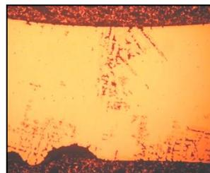
Une analyse XPS (X-Ray photoélectron spectroscopie) du défaut révèle la présence d'une forte concentration en oxyde de cuivre.
