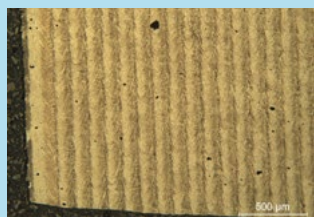
Microstructure pièce imprimée Or gris palladium 750‰ ; coupe longitudinale axe XZ
